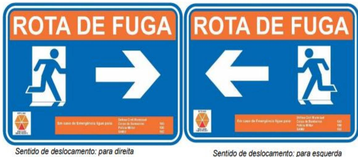
Figura 2-2 – Modelo de placa de Rota de Fuga
